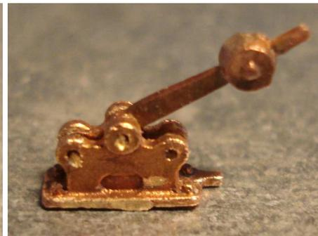
We geven er de voorkeur aan om de bedieningsstangen 6 en 8 op de kantelscharnier 5 te solderen, voor de montage, wat de stevigheid van de geheel te goede komt. Vooral als u gebruik maakt van zilversoldeer en soldeerwater zonder zuur.
