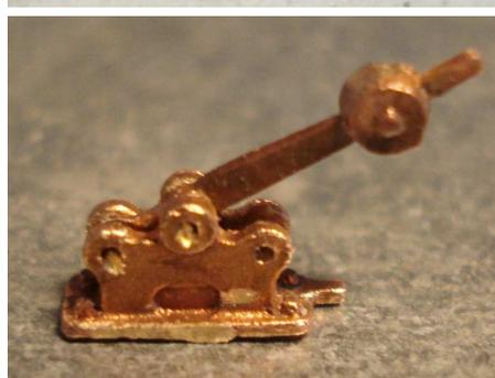
Nous préférons souder les deux barres de commande 6 et 8 sur le renvoi d'angle 5 avant leur montage, ce qui assure la solidité de l'ensemble surtout si vous employez de la soudure à l'argent et de l'eau à souder sans acide.
