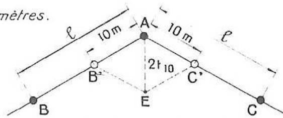
On fixe en B' et C' les extrémités de la corde que l'on tire par son milieu jusqu'à ce que les deux moitiés en soient bien tendues. Le nœud se trouve alors en un point E.
