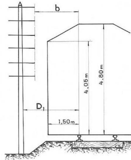
**b** désigne la distance en projection horizontale entre le rail extérieur et la position qu'occupe le fil téléphonique le plus voisin lorsqu'il n'est pas déporté par le vent.
