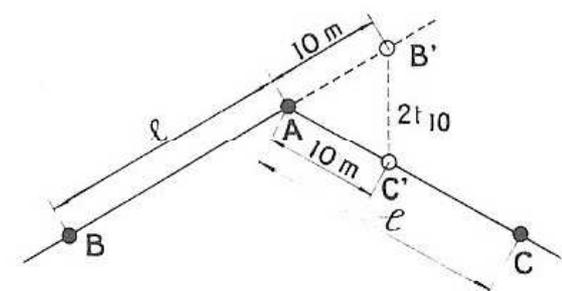
La distance entre les points B' et C' ainsi obtenue est égale au double du tirage réduit à 10 m.
