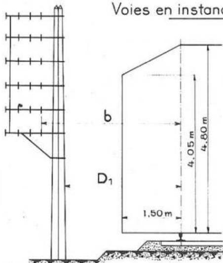
**b** désigne la distance en projection horizontale entre le rail extérieur et la position qu'occupe le fil téléphonique le plus voisin lorsqu'il n'est pas déporté par le vent.
