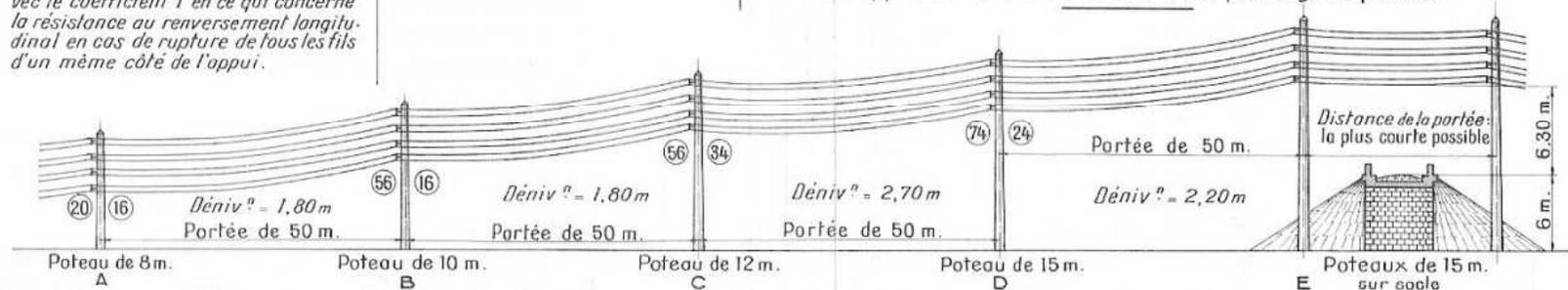
**Exemple.** — Soit une ligne armée à 4 traverses ayant à franchir un passage supérieur. Compte tenu de la flèche du fil à la plus haute température de la région et de la hauteur minimum de 6 m. entre le fil le plus bas et le niveau du sol, le point de fixation du fil le plus bas sur les appuis d'encadrement de la traversée doit être de 12,50 m. minimum au-dessus du sol. Ce point est à 12,80 m. au-dessus du sol en prenant des poteaux de 15 m. montés sur socle pour les appuis d'encadrement.
