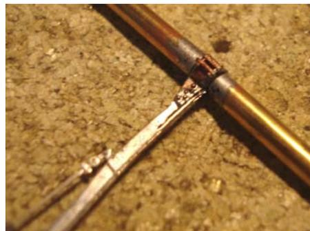
Dégrapper un tendeur et le plaquer par le milieu sur le plan de travail, mettre en place l'extrémité d'une tige de maillechort ou laiton de 0.3 mm dans l'échancrure, fluxer et souder.
