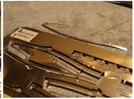
Badigeonner légèrement de soudure liquide, puis souder à la résistance électrique, ou au fer à souder si vous n'en avez pas, en maintenant les deux moitiés précisément ensemble.
