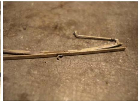
Immobiliser le plat ainsi inséré au niveau du crochet, puis le mettre en place avec une seconde brucelle à l'extrémité extérieure.
