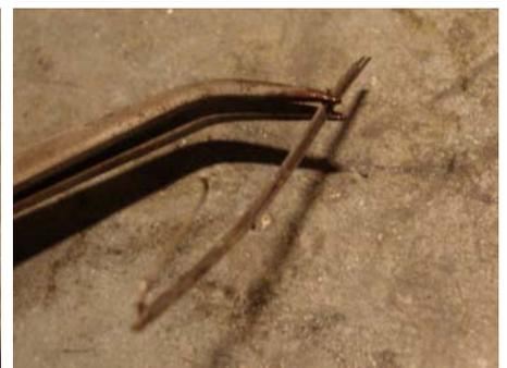
Plaquer le plat dans le creux de la console pour qu'il épouse bien la forme de celle-ci sur toute la moitié non encore soudée, puis fluxer et tirer une soudure tout le long de la seconde moitié.
