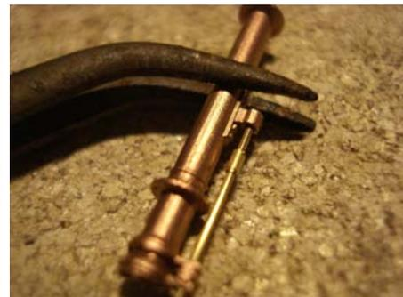
Descendre le fil et son tube jusqu'au contact de la portée inférieure, puis couper le fil en laissant environ un mm en haut pour l'engager dans la partie inférieure de la manche.
