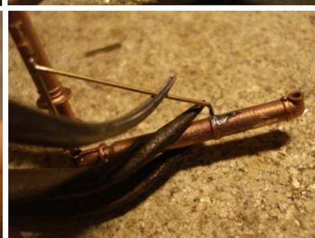
Souder maintenant le col sur le haut de la colonne : c'est par cette opération que les deux sous-ensembles sont immobilisés l'un par rapport à l'autre, souder depuis le côté sans immobiliser l'axe dans sa portée.
