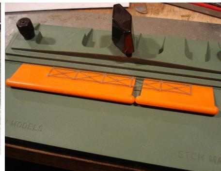
Voici l'aspect de la rambarde après pliage. Les rambardes sont constituées d'une pièce gravée et de potelets représentés par un fil de 0.5 mm, très visible.
