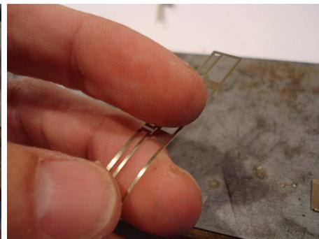
Les ailes inférieure et supérieure de chaque poutre sont constituées de deux pièces dos à dos.
