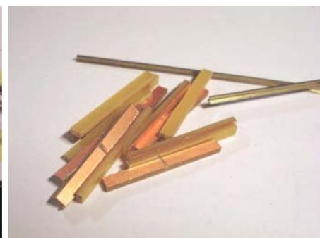
Les traverses mesurent 30 x 3 mm, compatibles avec la voie flexible Peco.
